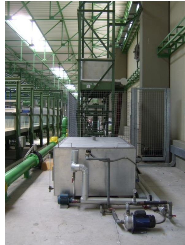
Canale di sezione rettangolare molto larga per lo studio di getti di densità, presso il LIC di Bari, in cooperazione col prof. Peter Davies (University of Dundee, UK)
